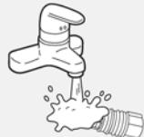
**3** - Svitate il filtro a maglie del bocchettoncino. Non utilizzate attrezzi metallici perché potreste danneggiare irreparabilmente la vite di tenuta: potete aiutarvi usando una moneta da 5c€ per rimuovere il filtro.
